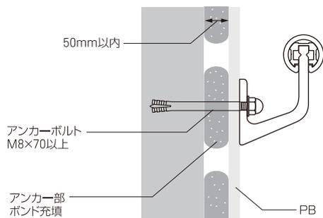
ALC+GL下地 (GLボンド補強)
