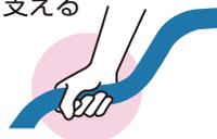
垂直部で「引きつける」、水平部で「支える」という機能性を加え、波形が生み出す高低差により体格差に関係なく歩行を楽にするため、2006年に施行されたバリアフリー新法は1段で、2段手摺と同等以上の機能を有するとして、適合商品となりました。
