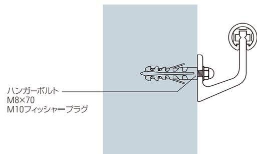
RC+GL下地 (GLボンド補強)
