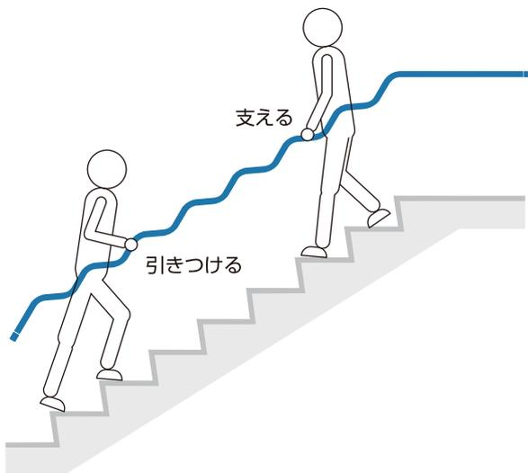
波型の形状は、垂直部で「引きつける」、水平部で「支える」という機能性により、従来の直線型手摺にくらべ手首の角度が自然なため、滑りにくく力が入りやすい構造となっております。
