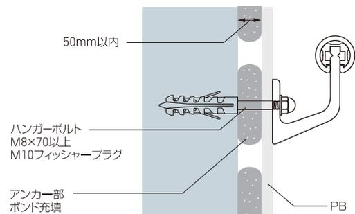
RC+GL下地 (サヤ管補強)
