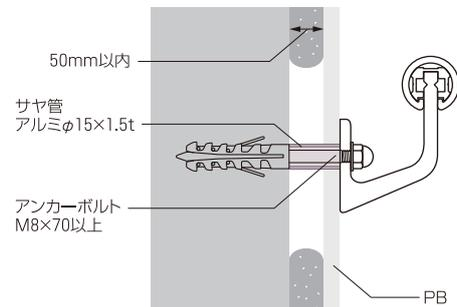
ALC+GL下地 (サヤ管補強)
