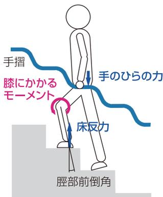
波型の形状は、手のひらで体重を支えやすくなる。脚を曲げる角度が小さくなり、負担が大幅に減少する。昇りの時、垂直面を引き付けることで、さらに床反力が減少する。また、両手で水平面と垂直面を支持することで体が安定する。
